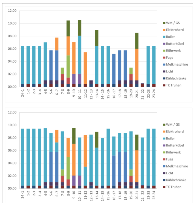
Abb. 6: Auslastung einer Inselanlage ohne (oben) und mit Lastmanagement (unten).
